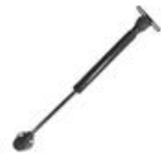
BRAZO HIDRÁULICO STANDARD Cod: REL-04BE Fuerza: 60, 80, 100 y 120 N Ciclos de apertura: 60.000
